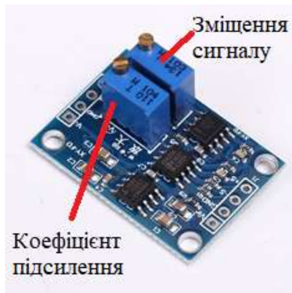
Рисунок 3.1 – Налагоджувальні резистори на модулі AD620
