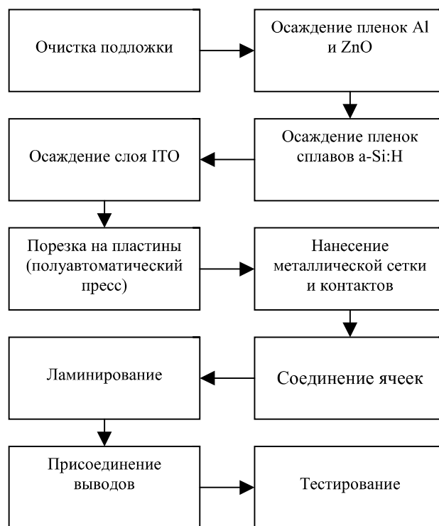
Рис. 6. Последовательность технологических операций в конвейерной концепции
