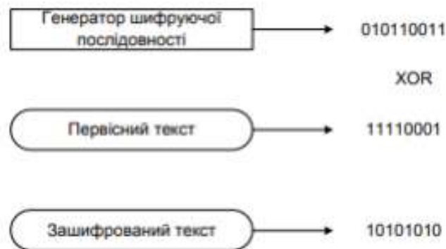
Рисунок. 1.2 – Узагальнена схема шифрування поточними шифрами (із прикладом)
