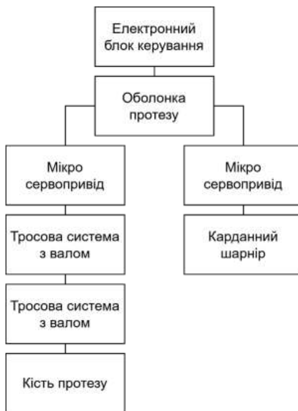
Рисунок 2.1 – Конструктивна схема протеза
