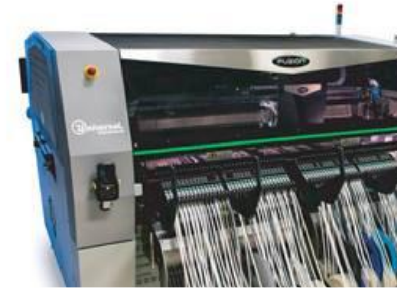
Рисунок 1.10 – Промисловий автомат встановлення елементів на ДП FuzionOF
