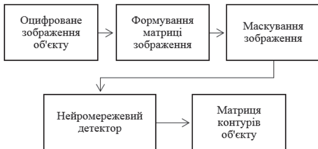
Рис. 3. Схема нейромережевого виділення контурів зображення
