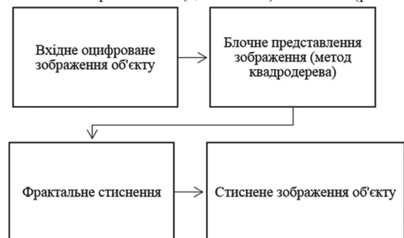
Рис. 6. Схема стиснення зображення з використанням фрактальної моделі та ГА
