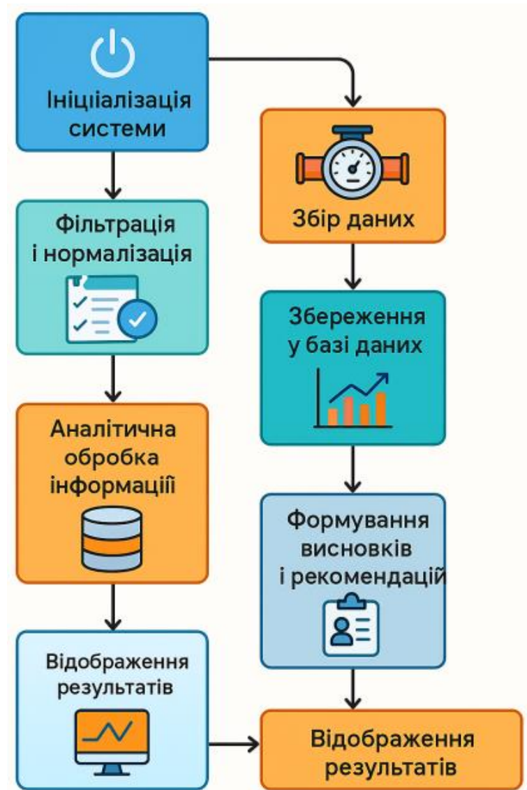
Рисунок 2.6 – Алгоритм функціонування автоматизованої системи обліку теплоспоживання
