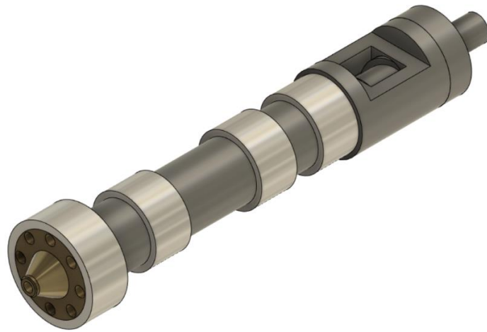
Рисунок 3.3 – Зовнішній вигляд розробленої 3D моделі шнекового екструдера
