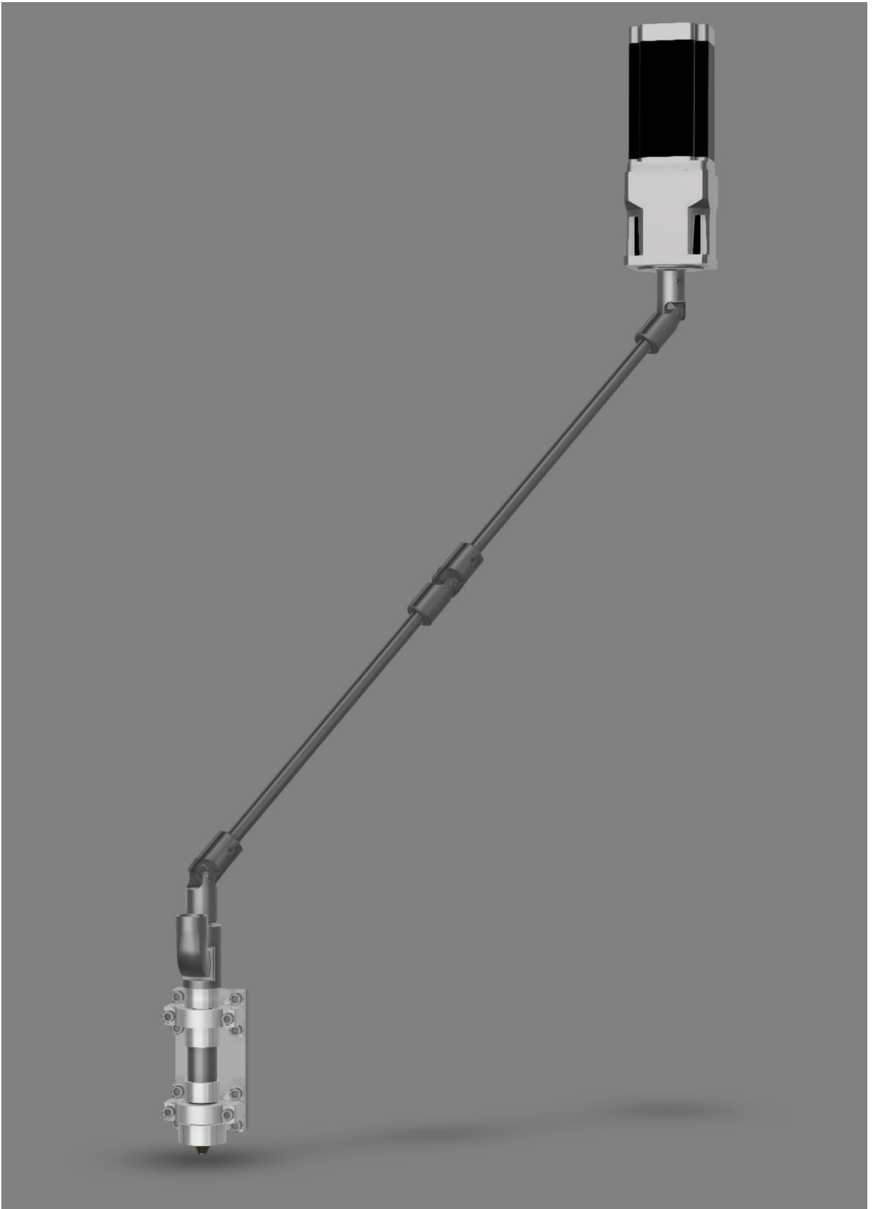
Рисунок 3.8 – Загальний вигляд поєднання шнекового екструдера та крокового двигуна
