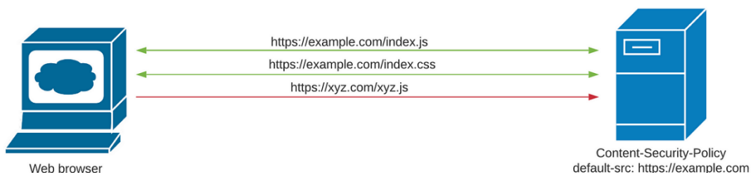
Рисунок 4.4 – Принцип роботи Content Security Police (CSP)
