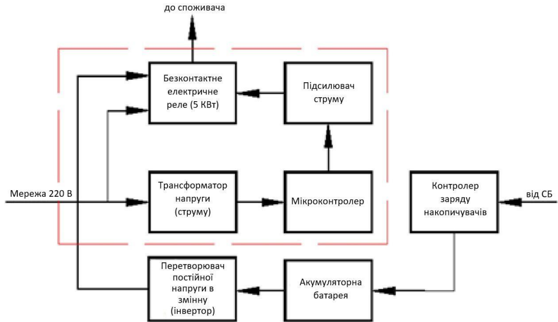
Рисунок 3.4 – Загальна структурна схема модуля резервного живлення (червоною штрихпунктирною лінією виділено комутатор електроенергії)
