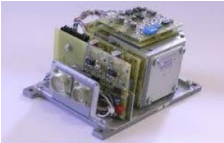
Рисунок 1.11 – Приклад безплатформної інерційної навігаційної підсистеми drone
