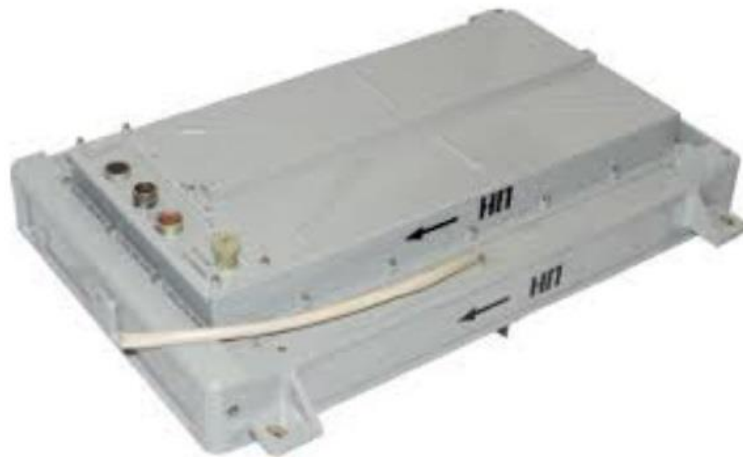
Рисунок 1.8 – Приклад датчика- доплерівського вимірювача швидкості та кута зносу
