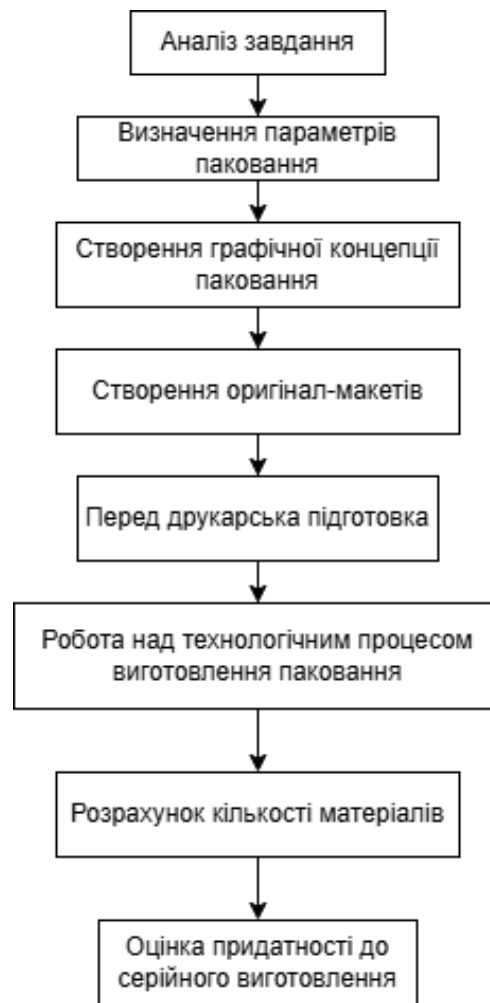
Рисунок 3.1 – Схема технологічного процесу виготовлення пакування
