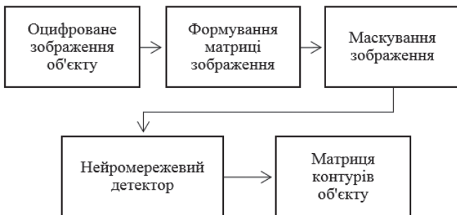
Рис. 3. Схему нейромережевого виділення контурів зображення
