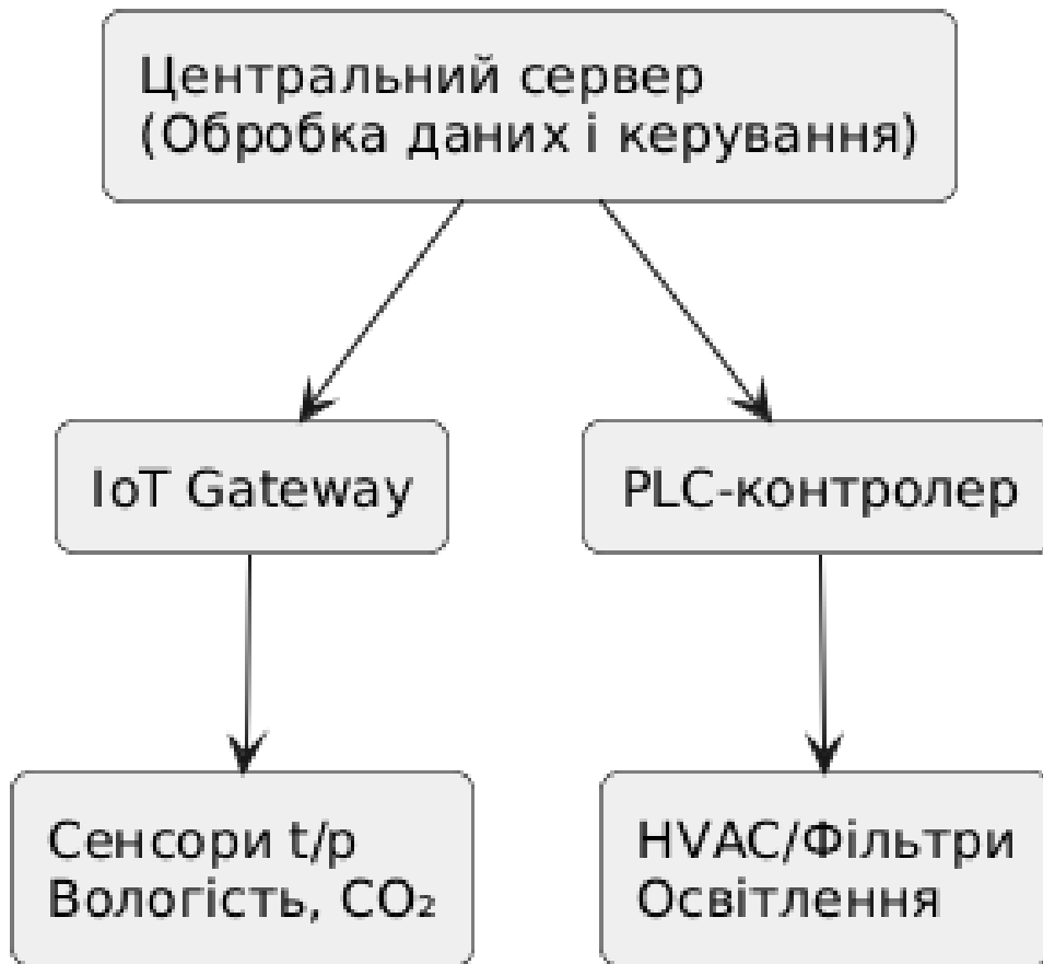
Рисунок 2.6 – Схема інтеграції сенсорів і периферійних пристроїв
