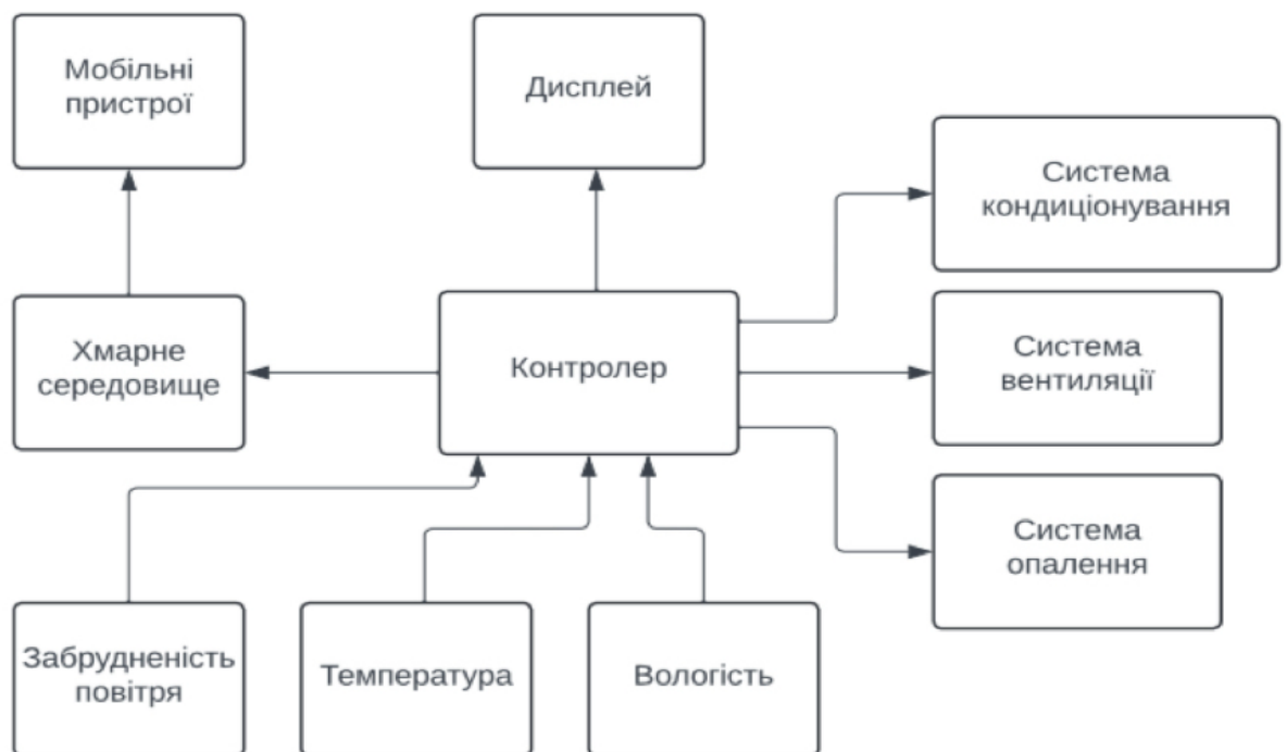
Рисунок 2.7 – Схема інтеграції сенсорів і виконавчих механізмів
