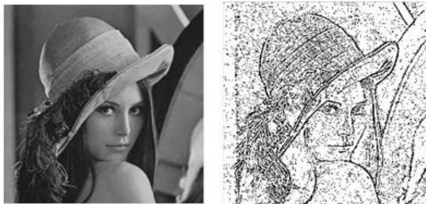
Рисунок 2.3 – Результат бінаризації зображення за допомогою адаптивного порогового значення
