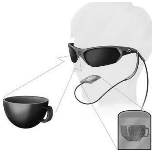
Рисунок 1.7 – Схематичне пояснення роботи BrainPort V100
