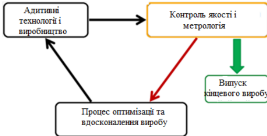
Рисунок 2.10 – Ітеративний процес оптимізації для проектування та виробництва деталей АВ на основі використання даних РКТ
