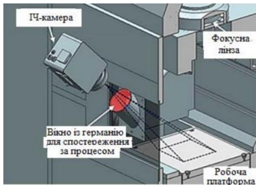
Рисунок 2.11 – Один із варіантів інтеграції ІЧ-установок в схему SLM-процесу
