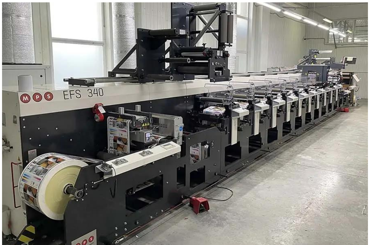
Рисунок 3.1 – Приклад флексографічної машини MPS
