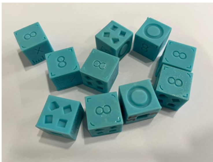
Рисунок 3.6 – Перевернені тестові зразки для дослідження
