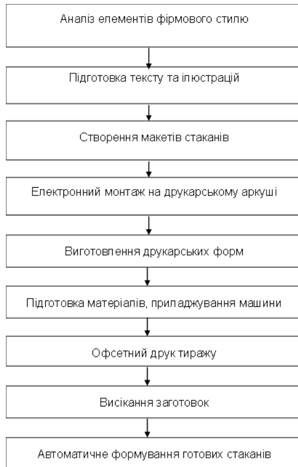
Рисунок 5.2 – Технологічна схема виготовлення стаканчиків офсетним друком
