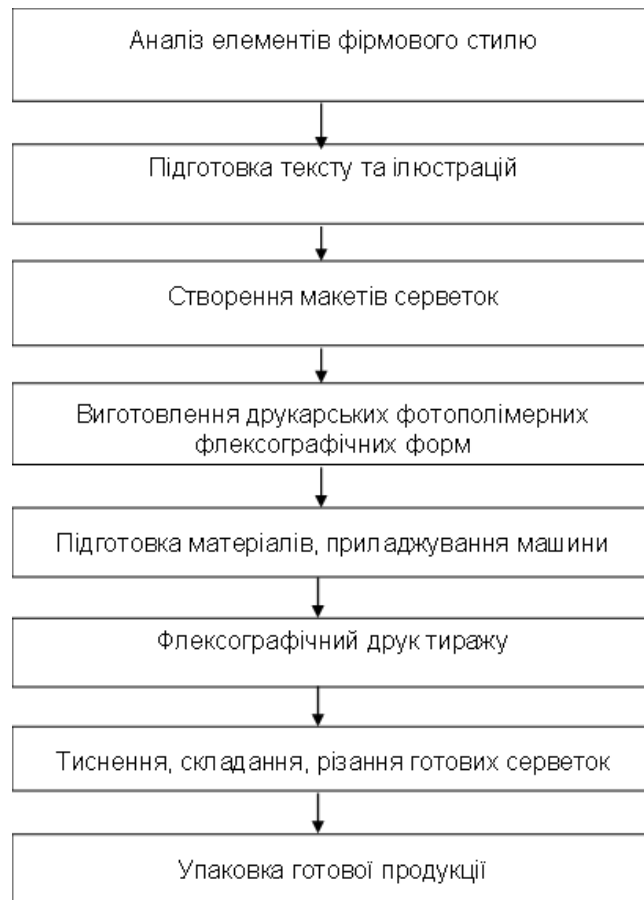
Рисунок 5.3 – Технологічна схема виготовлення фірмових серветок флексографічним друком
