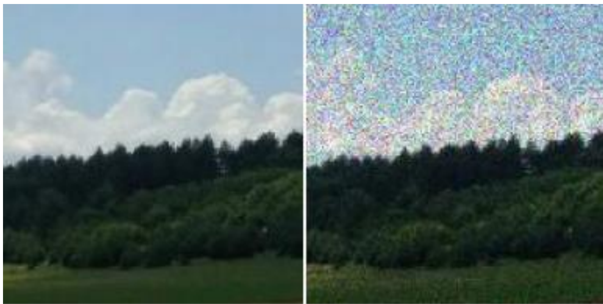
Рисунок 1.4 – Приклад накладання спекл-шуму на зображення
