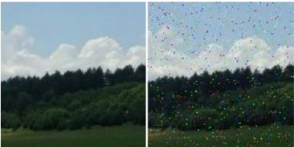
Рисунок 1.3 – Приклад накладання на зображення шуму типу «сіль і перець»
