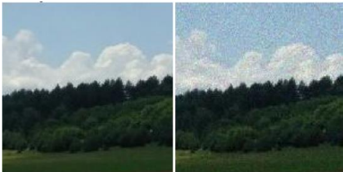
Рисунок 1.2 – Приклад накладання на зображення шуму Пуассона
