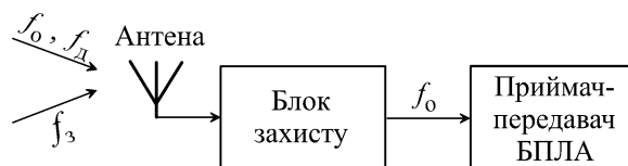
Рис. 1. Підключення блока захисту до приймача-передавача БПЛА
