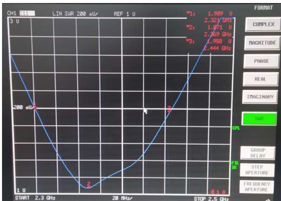
Рисунок 3.16 – Частотна залежність коефіцієнта відбиття |S_{11}| (а) та КСХН (б) експериментального зразка патч антени в смузі частот 2.3-2.5 ГГц
