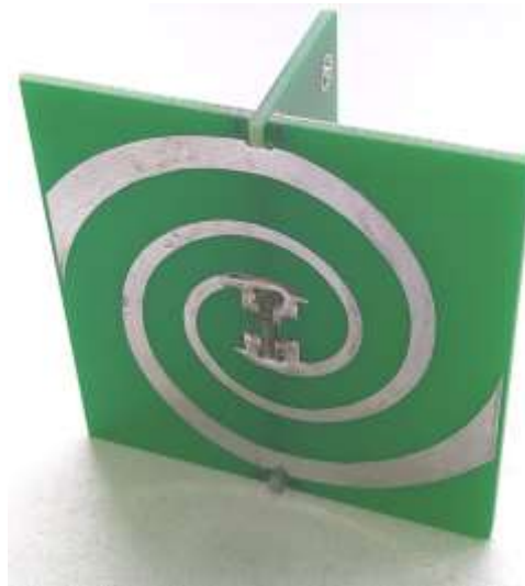
Рисунок 3.1 – Макет двозахідної логарифмічної спіральної антени з платою живлення
