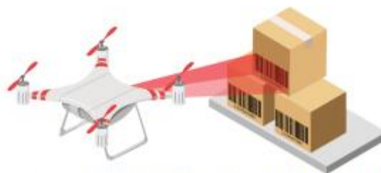
Рисунок 2 – Принцип роботи дрону для інвентаризації
