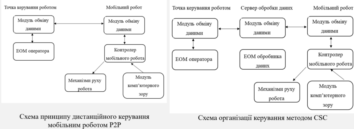
Рисунок Б.7 – Організація систем дистанційного керування мобільними роботами на основі Internet of Things технологій
