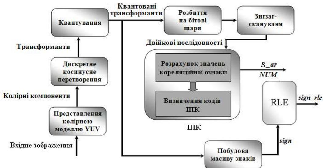
Рис. 1. Структурна схема технології стиснення на базі методу ІПК
