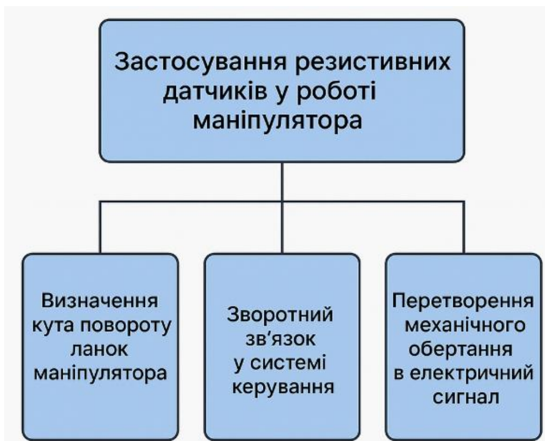
Рисунок 1.3 – Структура застосування резистивних датчиків у роботі маніпулятора
