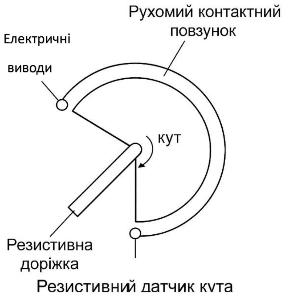
Рисунок 1.1 – Конструктивна будова резистивного датчика кута повороту
