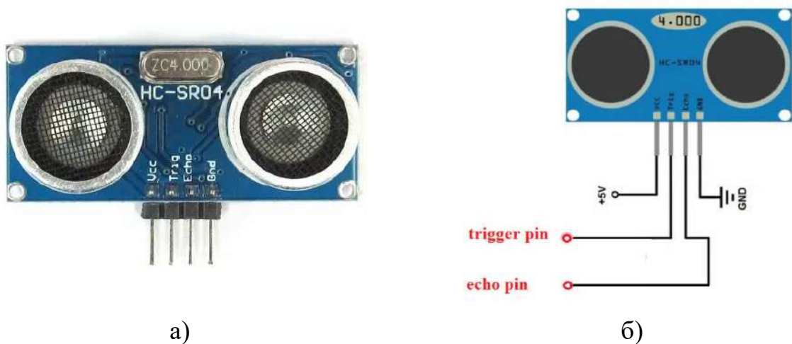
а) Загальний вигляд датчика HC-SR04; б) Призначення пінів датчика.
