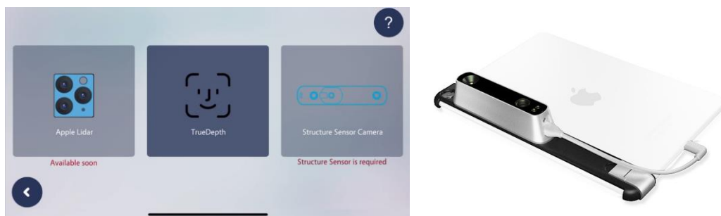
Рисунок 1 – Тривимірне сканування у Flyshape: а – доступні засоби тривимірного сканування у ПЗ Flyshape; б – 3D Structure sensor для iPad
