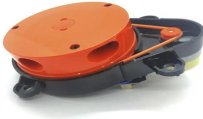
Рисунок 1.14 – Лідар для робота-пилососа від компанії Хіаомі
