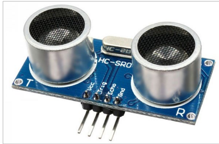
Рисунок 2.2 – Зображення датчика HC-SR04
