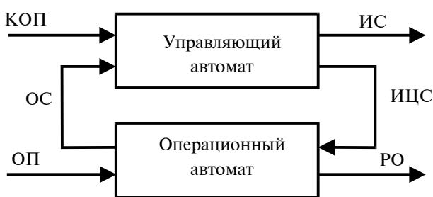
Рис. 2. Модель операционного устройства (ОС — оповестительные сигналы; ОП — операнды; РО — результат операции; КОП — код операции; ИС — индикация состояния; ИЦИ — инициирующие сигналы)
