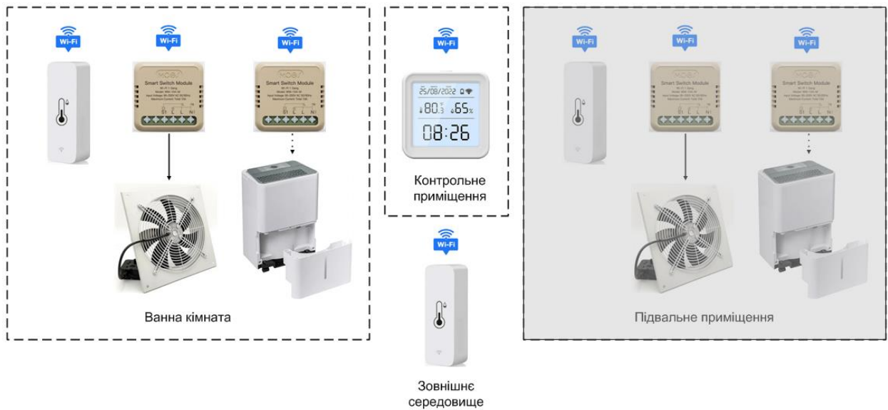
Рисунок 3.1 – Узагальнена структура системи контролю вологості
