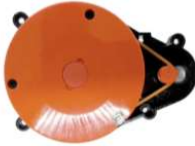
Рисунок 4 – Приклад лідару для робота-пилососа roborock lds лазерний датчик відстані LDS
