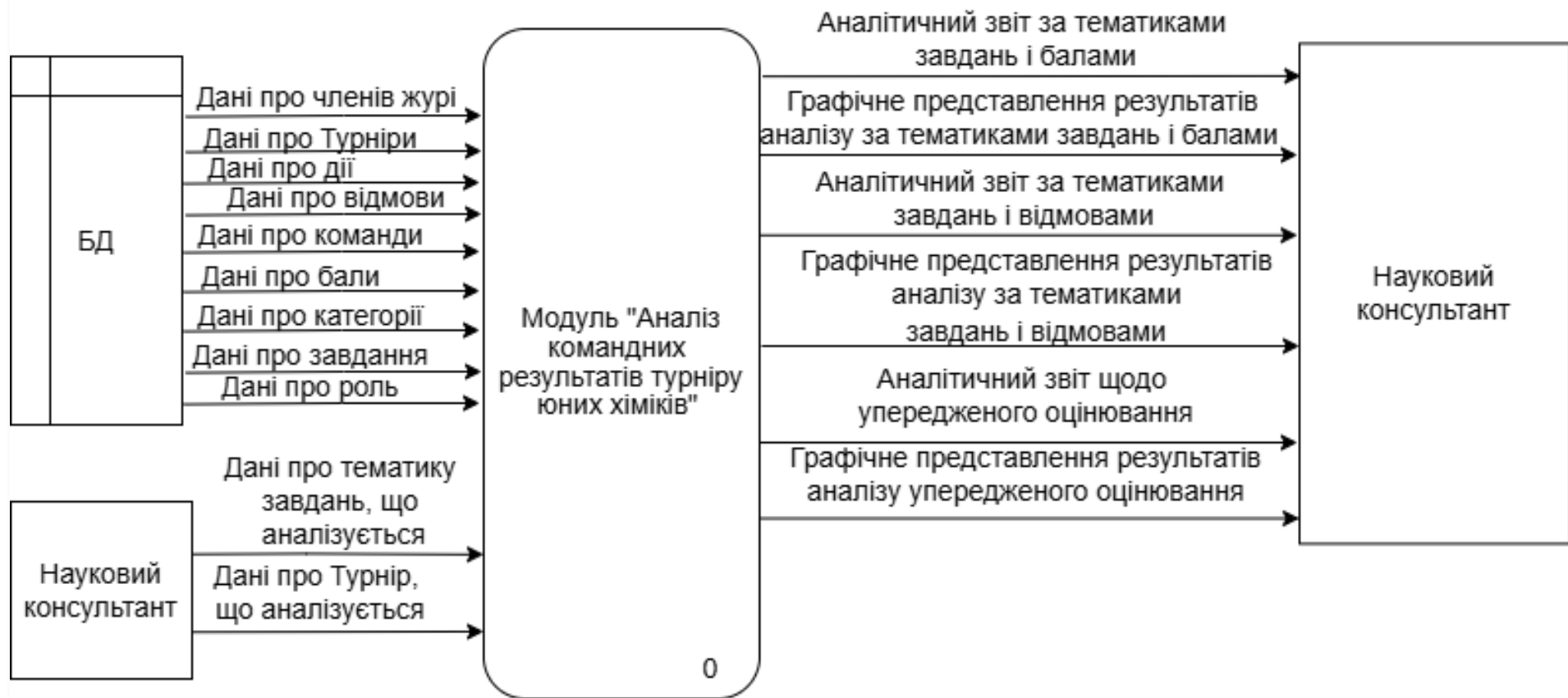
Рисунок 4.1 – Схема функціональної структури модуля «Аналіз командних результатів турніру юних хіміків» (контекстна діаграма)
