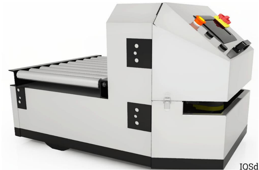
Рисунок 1.4 – Транспортні роботи з роликівим завантажувачем
