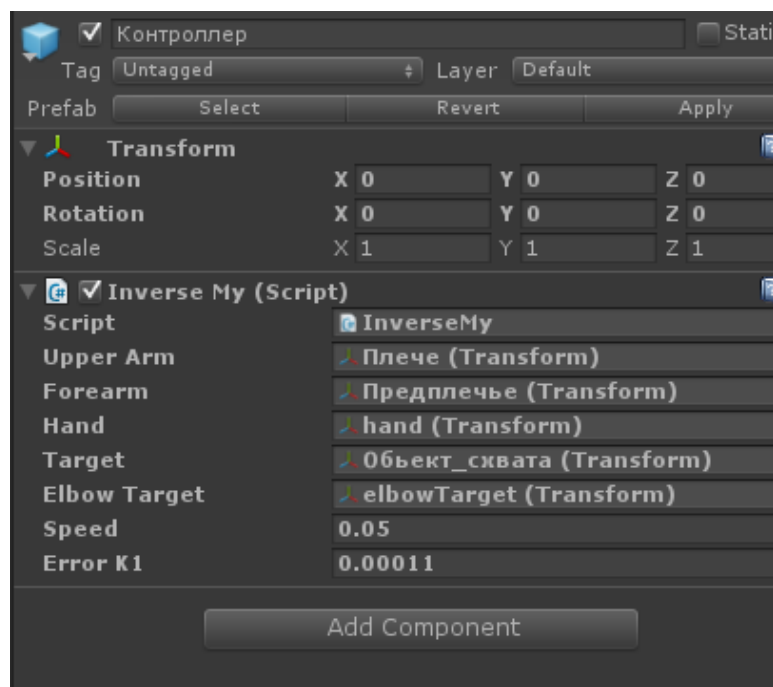
Рисунок 4.2 – Параметри керування маніпулятором
