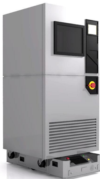
Рисунок 1.2 – Підйом вантажів шляхом під’їзду під кошик або візок
