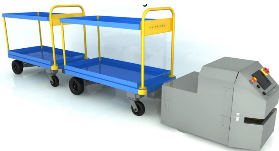
Рисунок 1.3 – Автоматизовані керовані транспортні засоби, що буксирують
