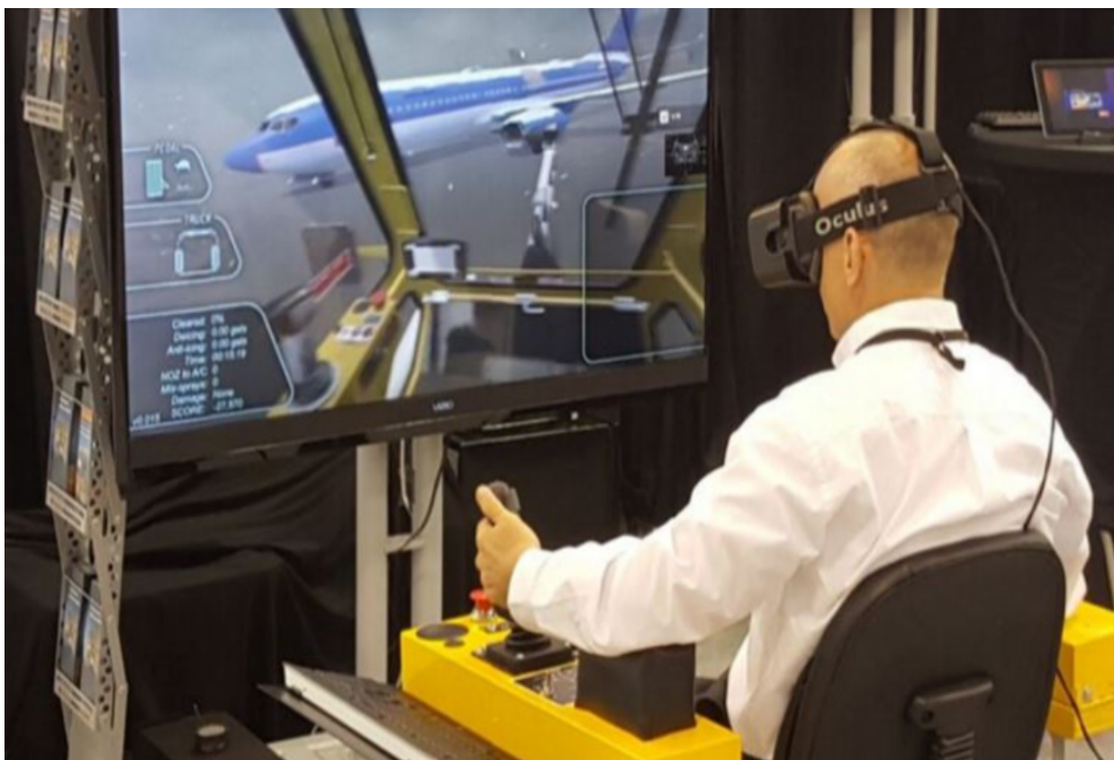
Рис - Симуляция чистки самолета от льда и снега
