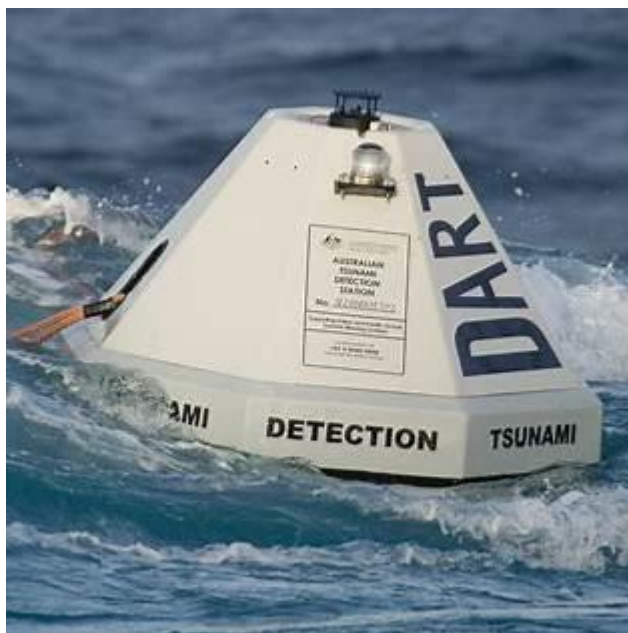
Рисунок 1.5 – Буї DART II, що формують першочергову лінію цунамі-сповіщення
