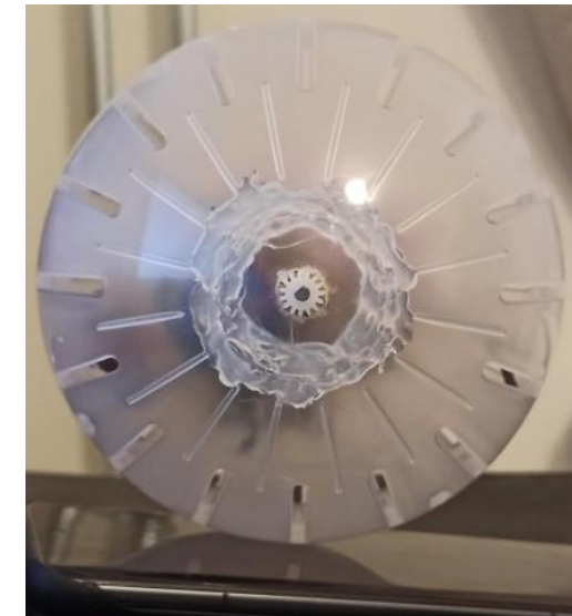
Рисунок 26 – Статика макету при нахилу 16^\circ
