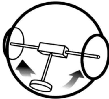
Рисунок 1 – Комерціалізований маятниковий робот Rotundus [3].
