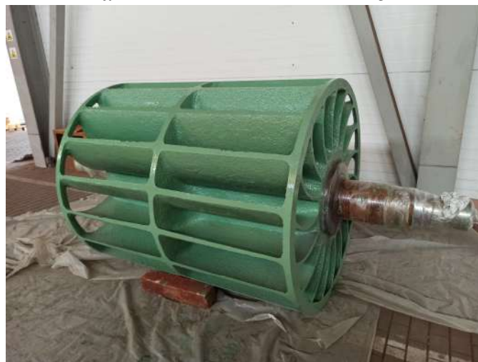
Рис. 1 – Ротор вакуум-насоса ВВН-400: а – зачистка лопаток; б – нанесення полімерного композиту; в – відновлений ротор
