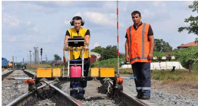
Рис. 1 – Застосування системи дефектоскопії на залізничних рейках
