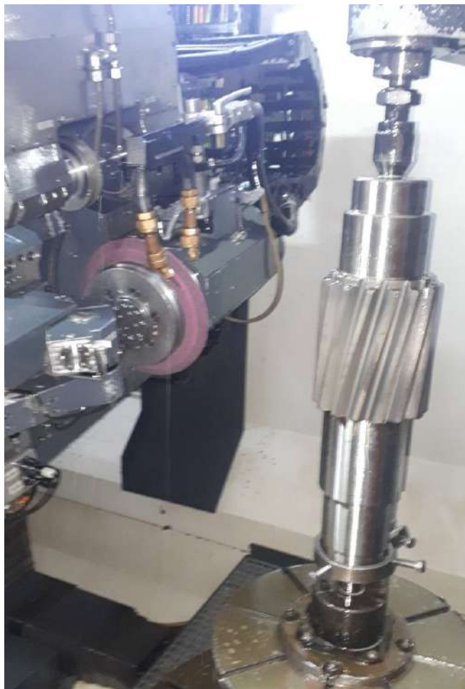
Рис. 1 – Установка шліфувального круга з рубін-корунду на верстат
