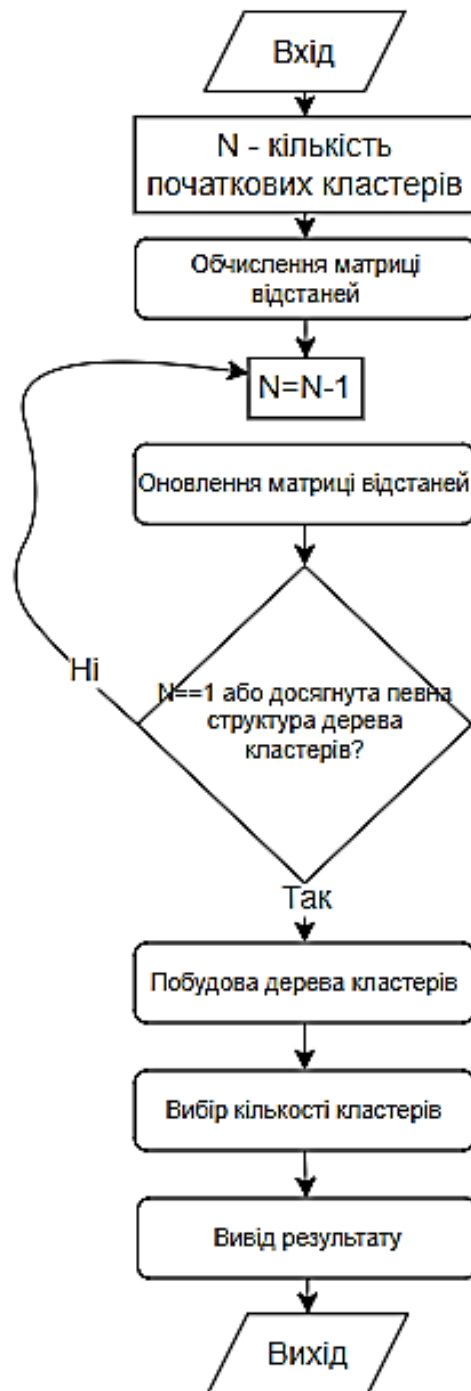
Рисунок 2.4 – Блок-схема роботи алгоритму агломеративної кластеризації
