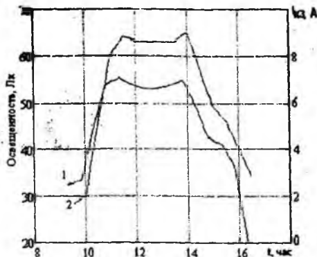
Рис. 10. Зависимости освещенности (1) и тока короткого замыкания (2) от времени суток
