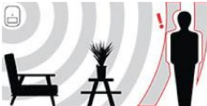
Рисунок 1.11 – Принцип роботи пасивного інфрачервоного детектора руху
