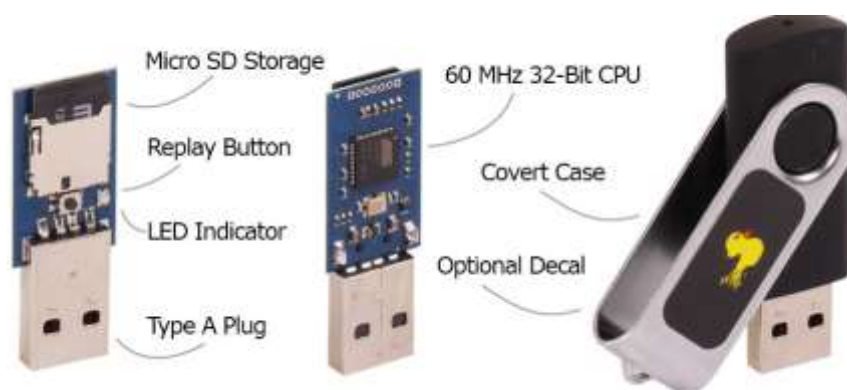
Рисунок 4.2 – Основні характеристики USB Rubber Ducky
