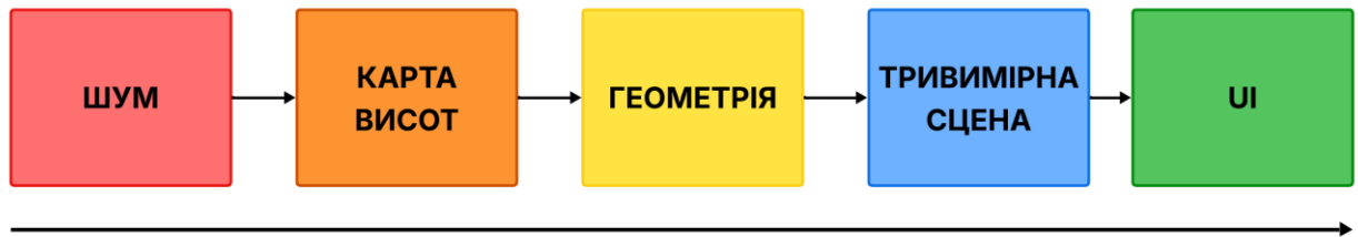
Рисунок 3.6 – Етапи формування тривимірного ландшафту від шуму до інтерфейсу користувача
