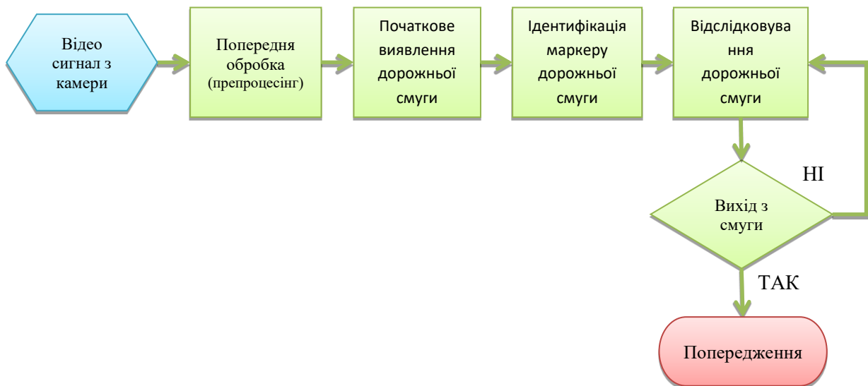
Рисунок 1.2 – Блок-схема простої системи попередження про схід зі смуги
