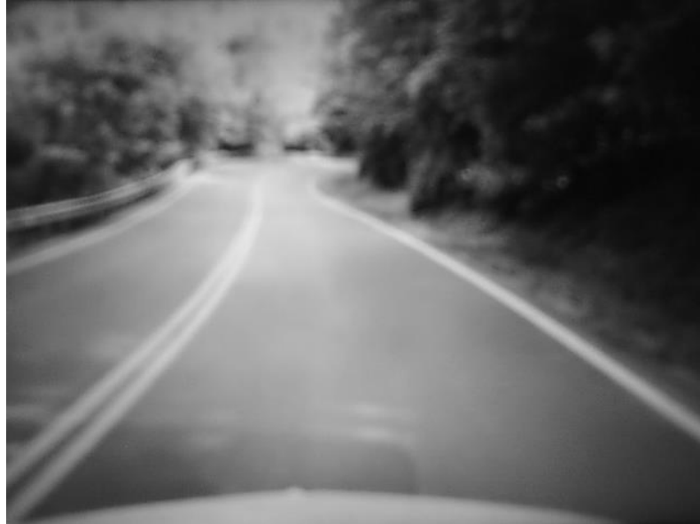
Рисунок 3.6 – Півтонове зображення після обробки фільтром Гауса
