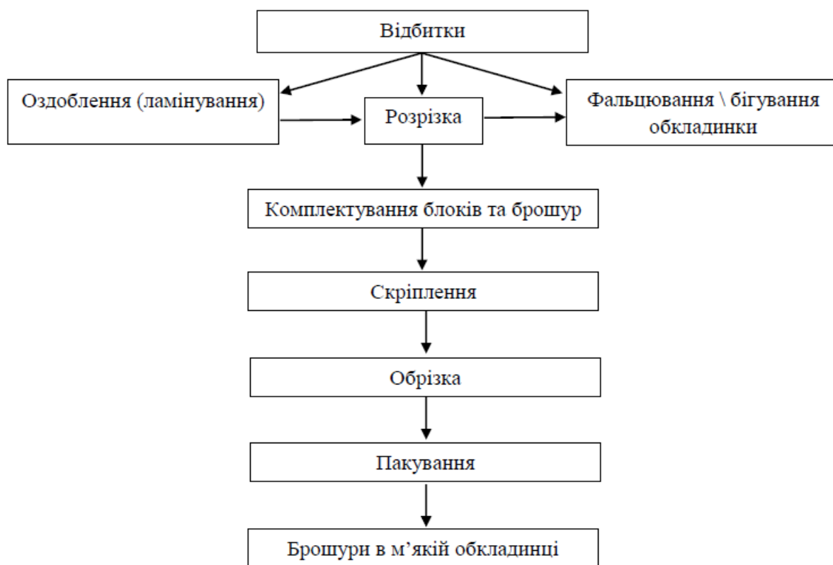
Рисунок 4.2 – Технологічний процес післядрукарського процесу
