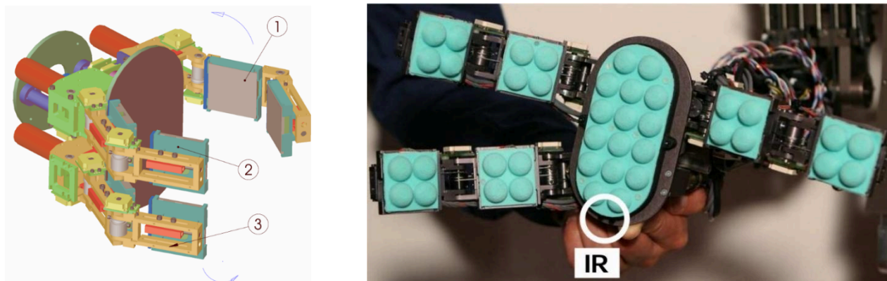
Рисунок 1.6 – Система OBRERO, в якій реалізовано принцип тактильного зворотного зв'язку [15]
