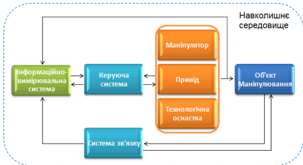
Рисунок 1.2 – Узагальнена структура робота, взаємодіючого з навколишнім середовищем [7]
