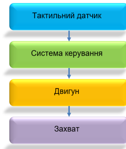
Рисунок 1.7 – Блок-схема взаємодії захватного пристрою
