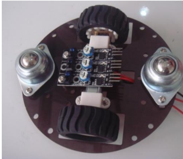
Рисунок 2.12 – Встановлений модуль відстеження трьох каналів
