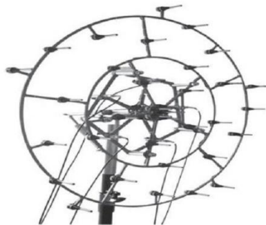
Рис. 1. Мікрофонна решітка BSWA-TECH SPS-980 [3]
